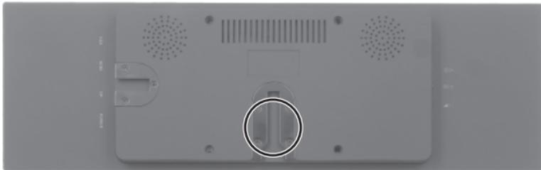
②本体締め付けホイールを緩め、本体のスタンドガイドに金属プレートをスライドさせるように取り付け、本体締め付けホイールを締めて固定してください。
